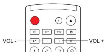
1. En el BDP-95EU, el control de volumen sólo afecta a la salida de audio la analógica. No afecta a la salida de audio digital (HDMI, Coaxial y óptica), ya sea en formato de flujo de bits (bitstream) o en formato LPCM.
